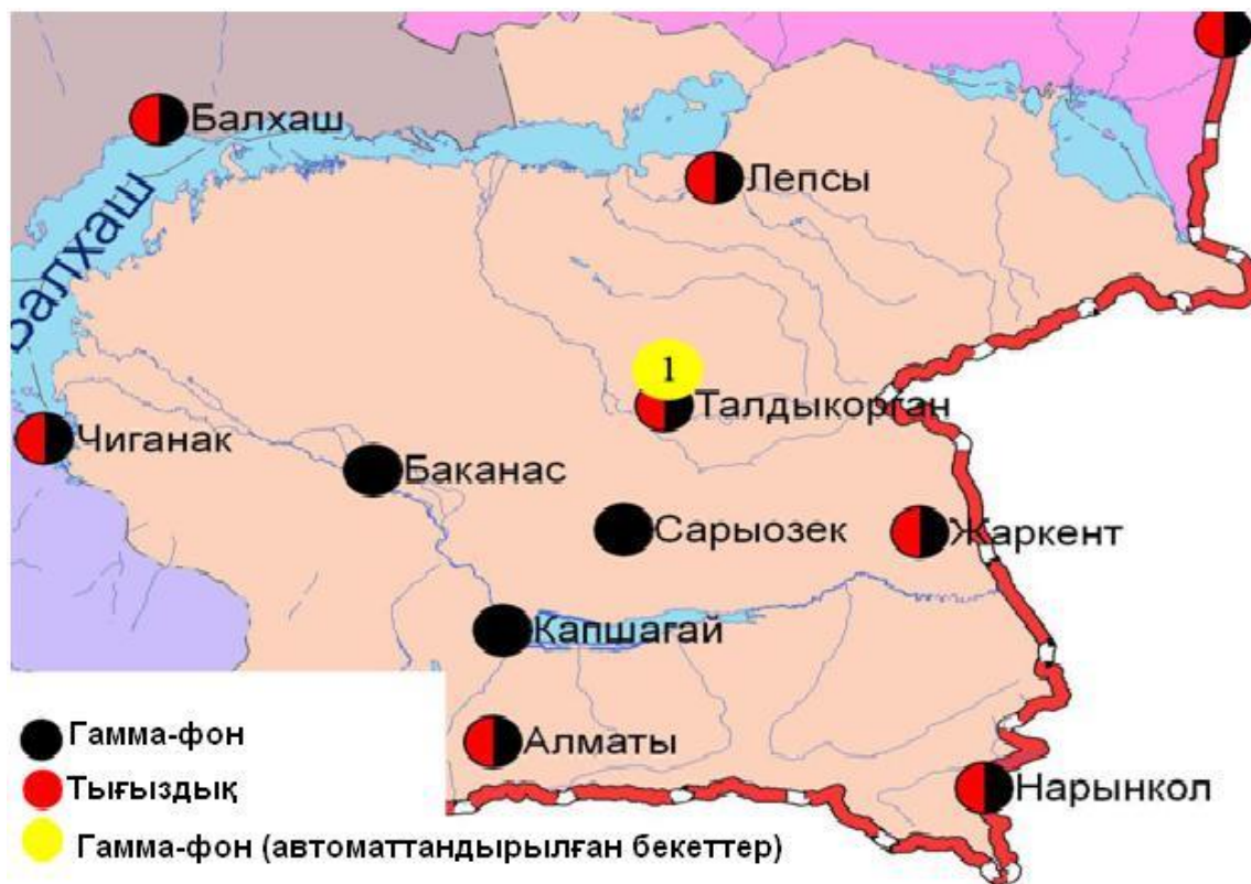
3.3-сурет. Алматы облысының аумағындағы радиациялық гамма-фон мен радиоактивті түсулердің тығыздығын бақылау метеостансаларының орналасу сызбасы.
